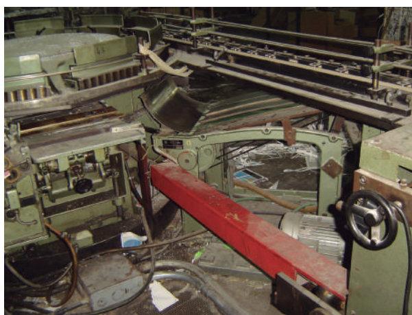
Dobladora de chapas y zona de riesgo de atrapamiento por caída.
