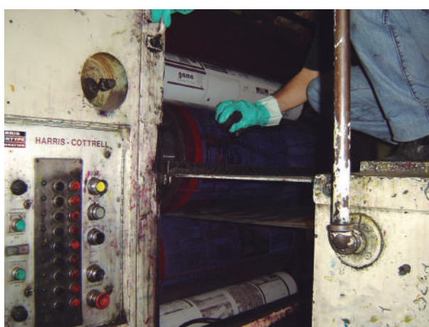
Limpieza de rodillos en movimiento y parada de emergencia.
