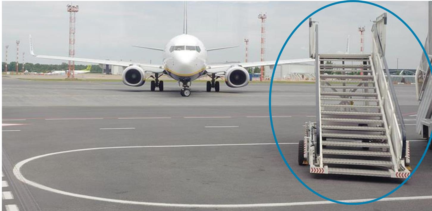
Un equipo terrestre sin asegurar es un potencial riesgo para una aeronave. Ya sea por el viento de una tormenta o por el mal empleo del mismo, puede causar daños por impacto.
