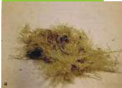
CRISOTILO O ASBESTO CAFE
